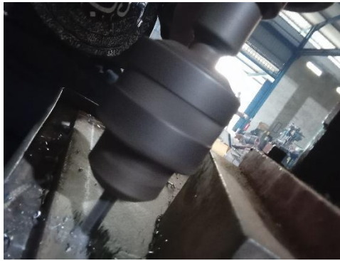
Gambar 2.5 Proses Pengeboran Lubang Baut
