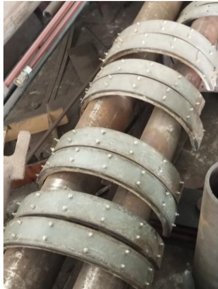
Gambar 2.3 Proses Pembuatan Kampas Rem Winch Jangkar Kapal
