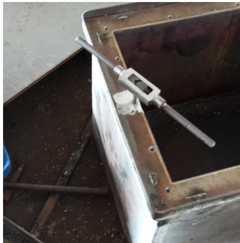
Gambar 2.6 Proses Pengetapan Lubang Baut
