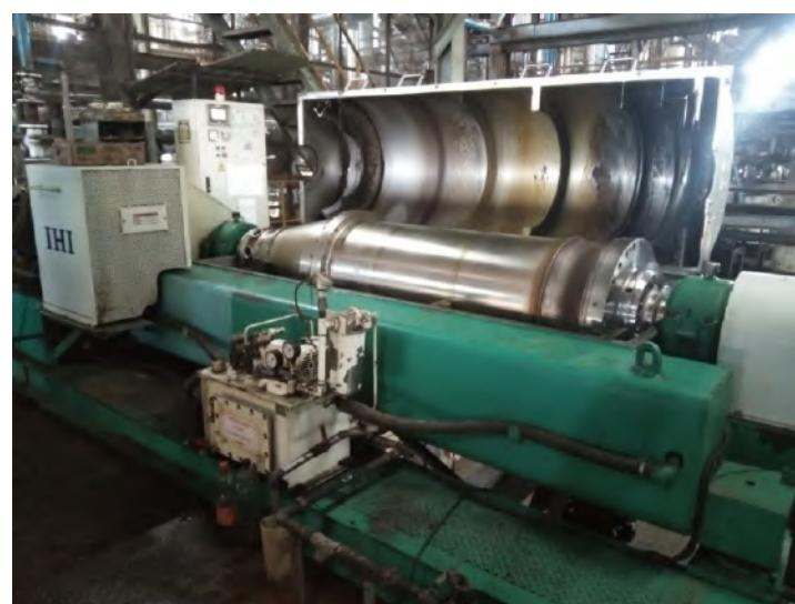
Gambar 2. 19 Mesin *Decanter*
