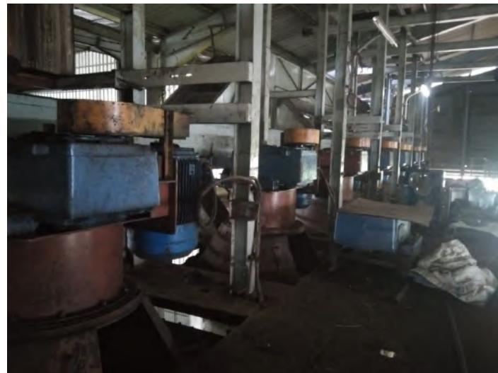
Gambar 2. 11 Mesin *Digester*
