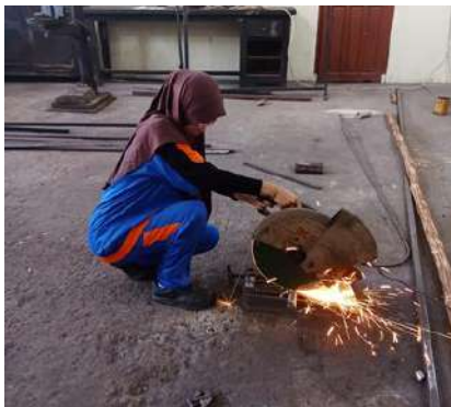
Pemotongan benda kerja bakal mesin menggunakan mesin gerinda
