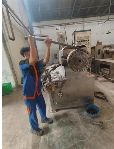
*Gambar 2. 7 Pengecekan Baut Mesin Extruder*
