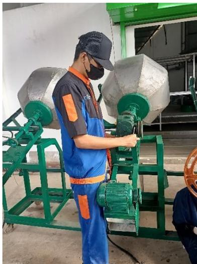
*Gambar 2. 4 Pemasangan Gear Box Mesin Molen*
