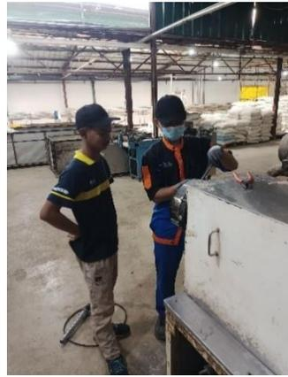
*Gambar 2. 2 Perbaikan Screw Mesin Extruder*
