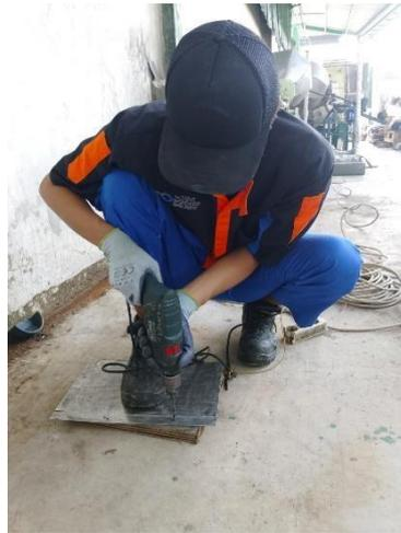
*Gambar 2. 8 Membuat Pembatas Loyang Mesin Extruder*
