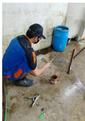
Gambar 2. 9 Pembersihan cetakan extruder menggunakan blender las
