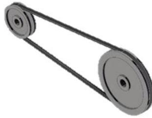
Gambar 2. 9 Desain 3D pulley dan v-belt
