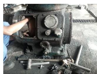
Mengganti plat strip *liner roller chain ffb conveyor*, cek *CS conveyor*, memperbaiki mesin *separator*
