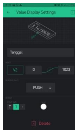
Gambar 4.20Setting widgetpenampil tanggal di blynk
