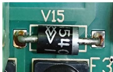
Gambar 4. 5 Komponen Dioda
