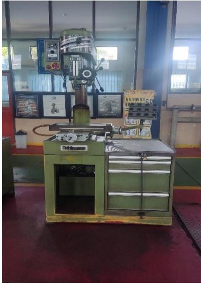
Gambar 2. 2 Mesin Frais Fehlmann P18s
