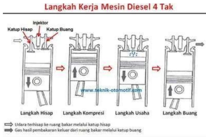
Gambar 1.8 Langkah Kerja Mesin Diesel 4 Tak
