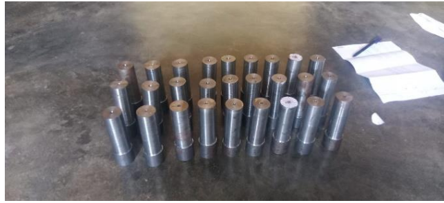
Gambar 4. 1 Spesimen uji setelah proses permesinan dan pemberian nomor
