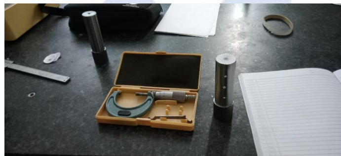
Gambar 4. 2 Spesimen yang siap diukur kesilindrisan
