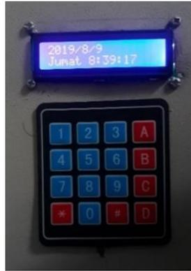
Gambar 4. 23 Tampilan LCD dengan menggunakan *keypad*
