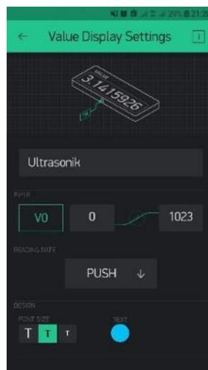
Gambar 4. 16 Pengaturan komponen ultrasonik
