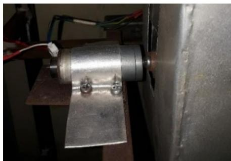
Gambar 4. 7 Peletakkan motor DC 12 volt
