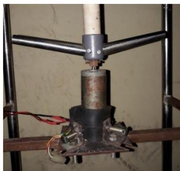
Gambar 4. 9 Penempatan motor DC 24 volt
