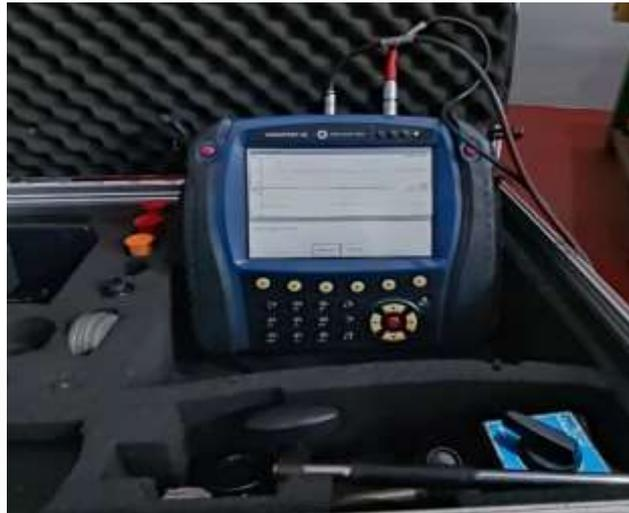
Gambar 3. 6 Alat Uji Vibroport 80
