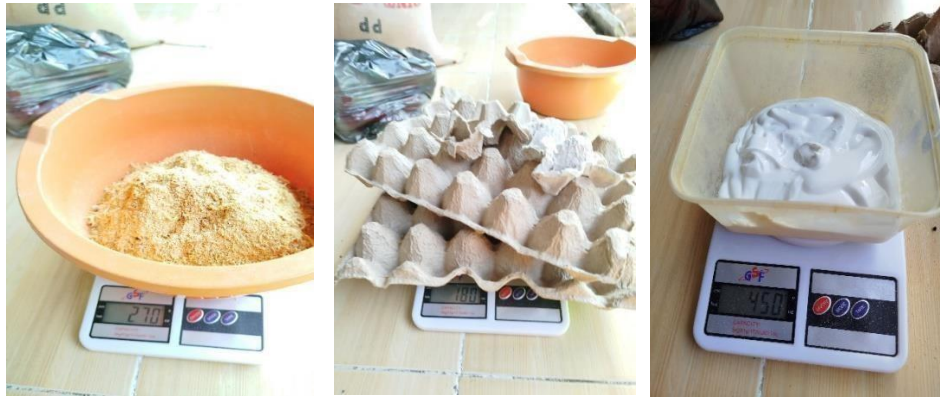
Sampel 5. (35% : 15% dengan ketebalan 20 mm)
