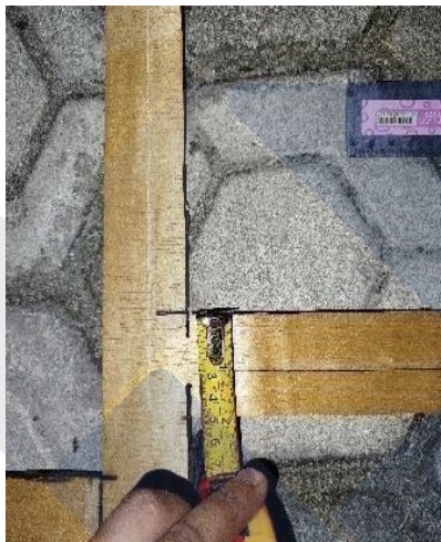
Gambar 4. 11 Pengukuran tebal 10 mm dan 20 mm (Dok.Pribadi)
