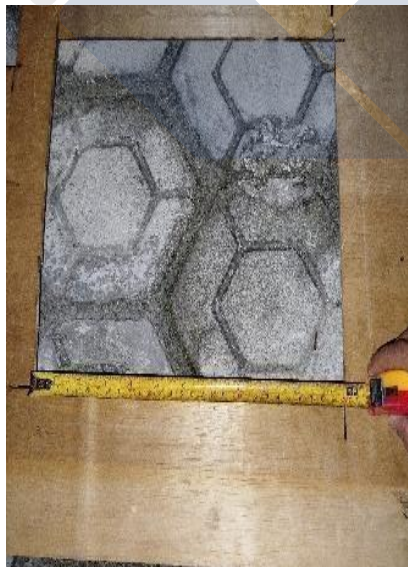
Gambar 4. 9 Pengukuran panjang 300 mm (Dok.Pribadi)
