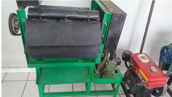
Gambar 1.1 Mesin Pengupas Sabut Kelapa Tahun 2023
