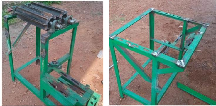
Gambar 4.12 Membongkar Komponen Dan Rangka Mesin
