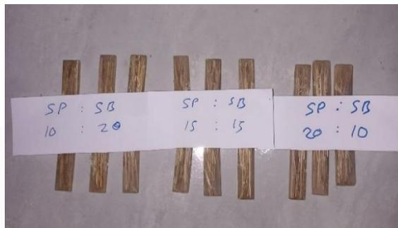
Gambar 4.2 Spesimen Uji Impak
