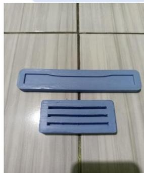
Gambar 3.3 Cetakan Uji Tarik Dan Uji Impak
