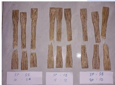
Gambar 4.4 Hasil Pengujian Spesimen Tarik
