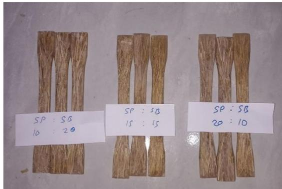
Gambar 4.1 Spesimen Uji Tarik
