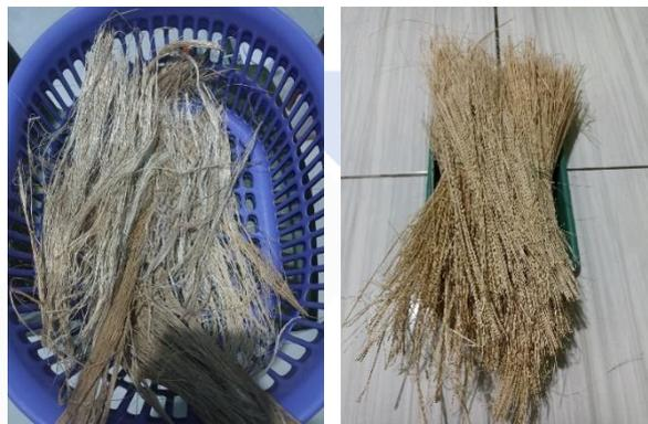
Gambar 3.9 Serat Batang Pisang dan Serat Bambu
