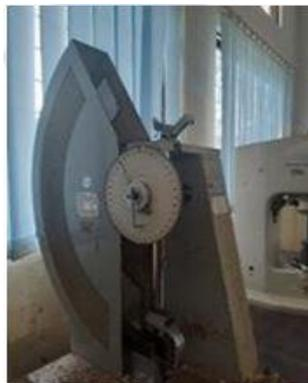
Gambar 3.15 Alat Uji Impak
