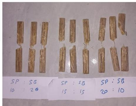
Gambar 4.6 Hasil Pengujian Spesimen Impak
