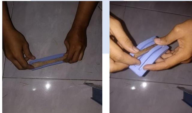
Gambar 3.26 Pelepasan Komposit Dari Cetakan
