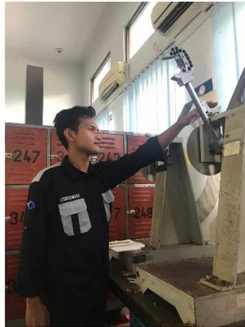
Gambar 4.5 Proses Pemasangan Spesimen Pengujian Impak
