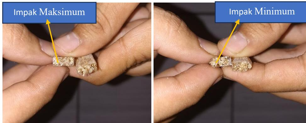
Gambar 4.12 Spesimen Uji Impak Maksimum dan Minimum
