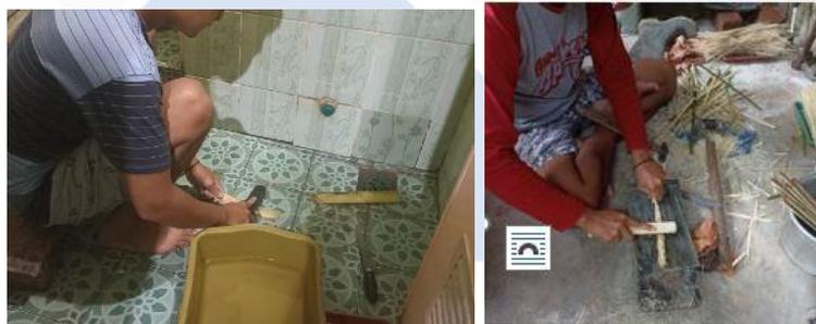
Gambar 3.19 Proses pengambilan Serat Pisang dan Serat Bambu
