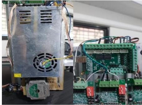
Gambar 4. 6 Perakitan *Power Supply* dan *Driver Motor Stepper*
