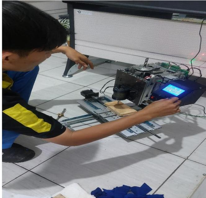
Foto pengujian pemakanan dengan menggunakan benda kerja kayu
