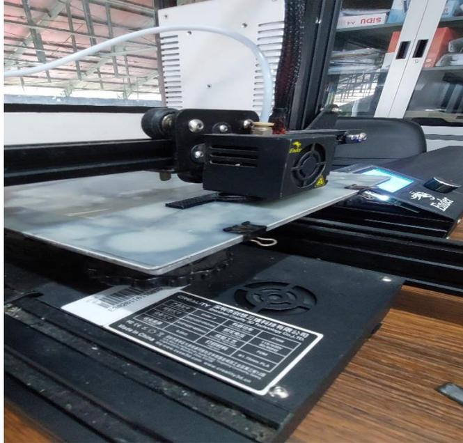
Foto proses melakukan pembuatan dudukan bearing menggunakan 3D printer
