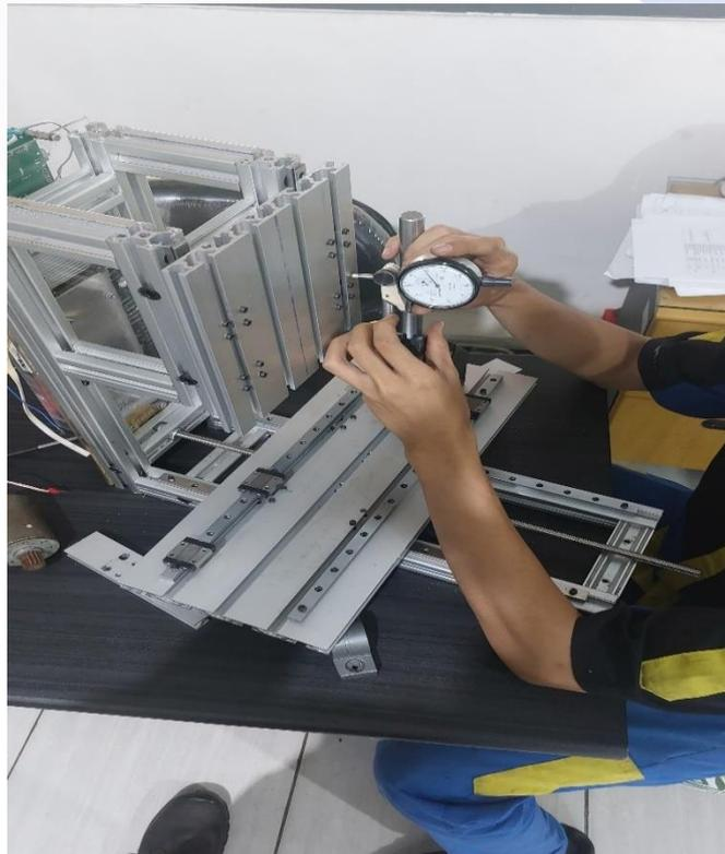
Foto proses melakukan pengujian geometri dan uji presisi
