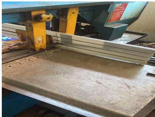
Gambar 4. 2 Pemotongan Alumunium Profil
