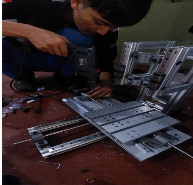
Foto proses melakukan pengeboranudukan bearing pada alumunium profil
