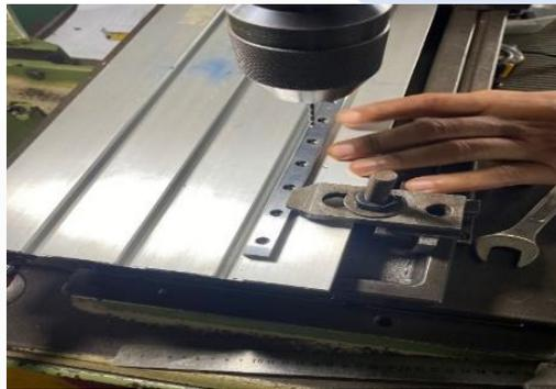
Gambar 4. 3 Pengeboran Pada Alumunium Profil
