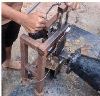
Gambar 4.21 Assembly rangka ke mesin pencetak briket
