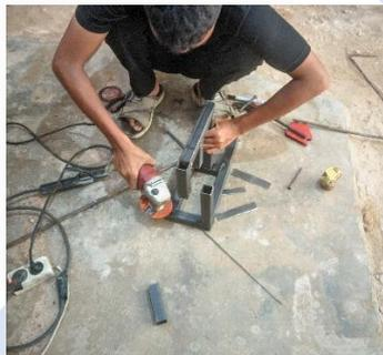
Gambar 4.20 Pembersihan sisa pengelasan pada rangka
