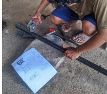
Gambar 4.17 Pemotongan besi holo dan plat besi
