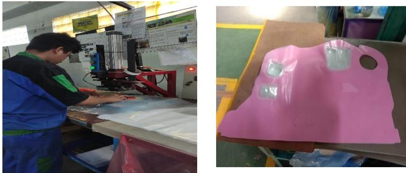
Cover service hole berfungsi sebagai melindungi elektrical pada pintu mobil. Bahan utama pembuatan *door service hole* adalah *Plastic Polypropylene* (PP). Salah satu tahap dalam pembuatan *door service hole* adalah proses *welder* yang dilakukan penulis selama membantu *produksi door service hole*. Berikut tahapan dalam proses *welder service hole*:
