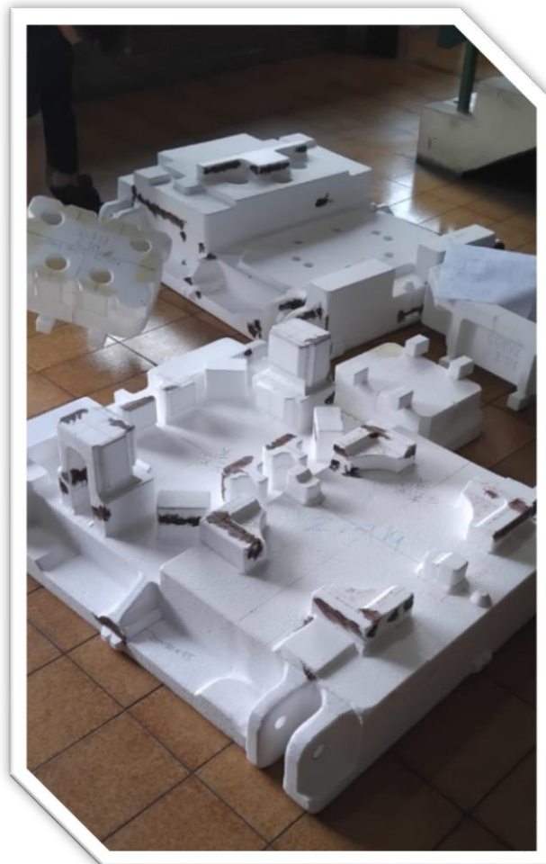
Gambar 2.4 POLA DIES/HAPPO Terbuat dari styrofoam
