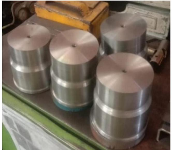
Gambar 2. 7 Komponen Dies Hasil Proses Machining
