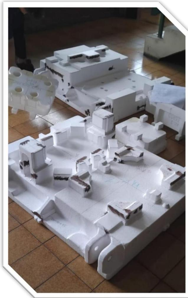
Gambar 2. 5 Pola Dies / Haplo terbuat dari Styrofoam
