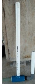
Gambar 4.2 Perakitan pemipaan micro-bubble ( nozzle jsw 8)
