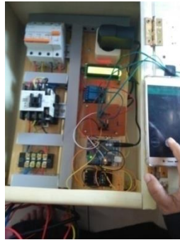
Gambar 4.33 Hasil pengujian push-button OFF ditekan di android
