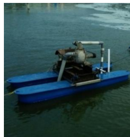
Gambar 4.3 Hasil perakitan kontruksi alat peningkat kadar oksigen
