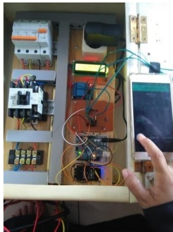
Gambar 4.37 Penyalan pompa mode auto (android)
