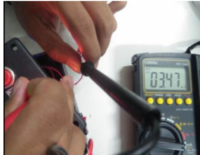
Gambar 4.20. Hasil pengukuran arus pulse sensor
