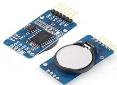
Gambar 4.27. Bentuk fisik dari RTC DS3231[20]
