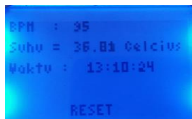
Gambar 4.42. LCD menampilkan BPM , suhu tubuh dan waktu
