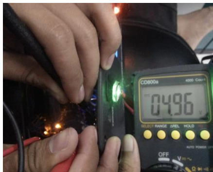
Gambar 4.25. Hasil pengukuran tegangan Sensor MLX90614
