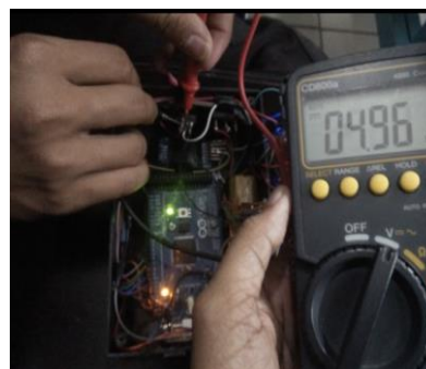
Gambar 4.19. Hasil pengukuran tegangan pulse sensor
