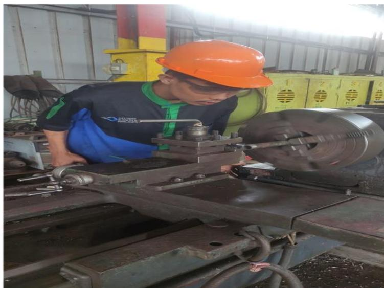
Gambar 2.1 Proses Pembuatan ulir pada pipa
