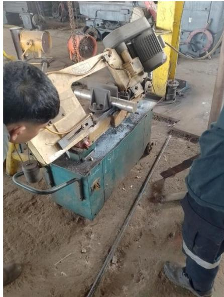
Gambar 2.5 pemotongan menggunakan mesin Gergaji pita *horizontal*
