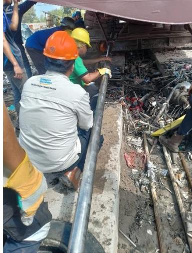
Gambar 2.8 proses pemasangan *propeller shaft*
