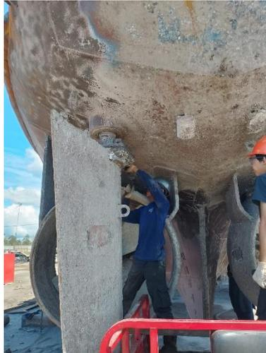
Gambar 2.7 Proses pelepasan Rudder ( *Daun kemudi* )
