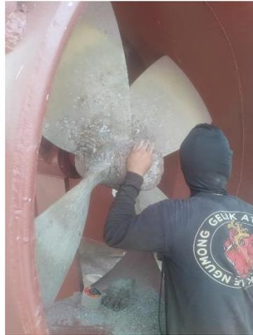
Gambar 2.11 Proses pembersihan baling-baling
