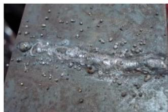
**Gambar 2.15** Spatter pada Pengelasan
