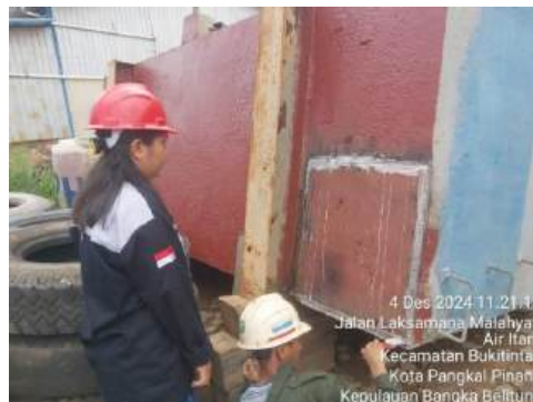
Gambar 2. 22 Test keborocan tangki minyak
