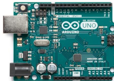
Gambar 2.4 Arduino Uno R3
