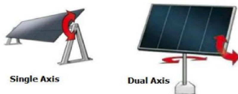
Gambar 2.1 Jenis solar tracker berdasarkan sumbu putar.
