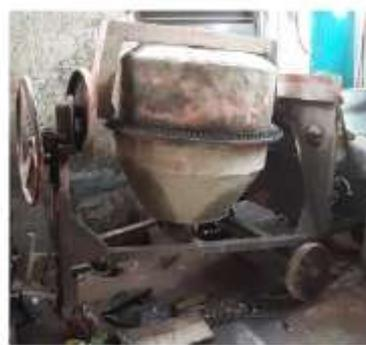
Gambar 1. 2 Mesin Molen Kapasitas 100 Kg
