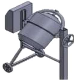
Gambar 1. 3 Desain Mesin Molen Kapasitas 50 kg.
