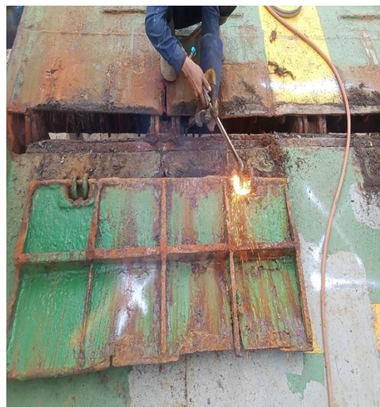
Gambar 1.30 Repair Lidah-lidah Ramp door depan kapal KMP Gurare.
