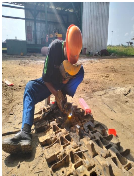
Gambar1.24 Melakukan Penebalan Track Kobelco
