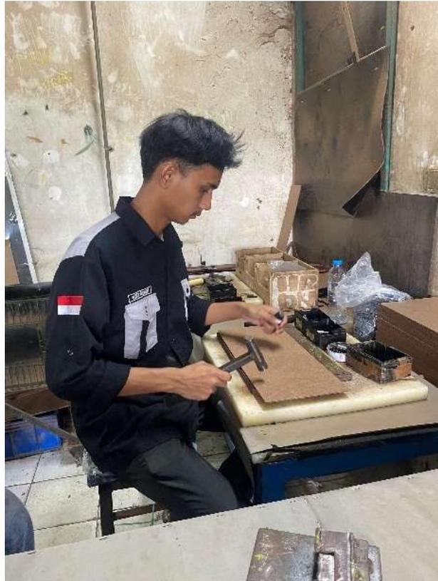
Gambar 2. 9 Proses Merekatkan Clip/Pegas kedalam Material Backsea
