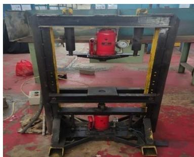
Gambar 3. 8 *Mesin Press Hidrolik*
