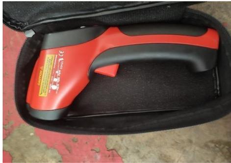
Gambar 3. 11 Alat Pengukur Suhu (*Thermogun*)
