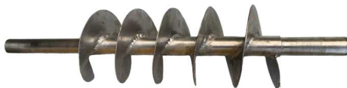
Gambar 2. 3 Screw Conveyor (Sumber: Dokumen Pribadi)
