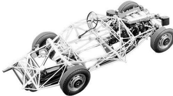
Gambar 2. 5 Jenis Rangka *Tubular Space Frame*
