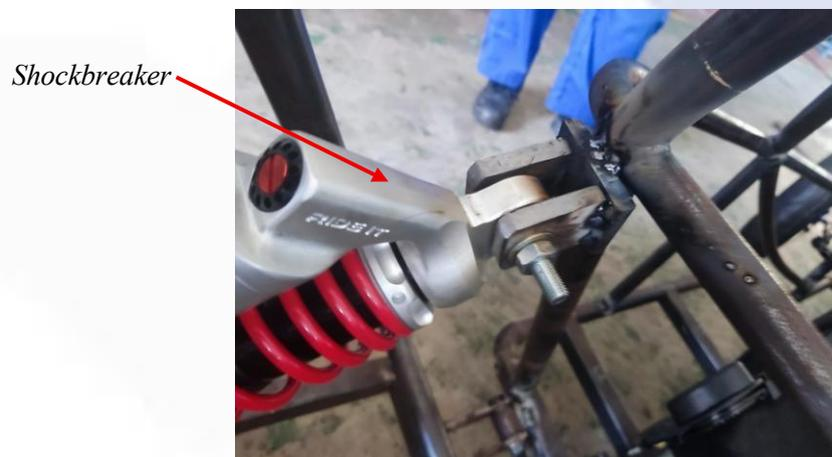
Gambar 4. 14 Proses Pemasangan *Shockbreaker* Masuk Dalam Pelat Telinga
