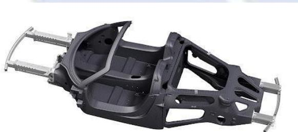
Gambar 2. 4 Jenis Rangka *Monocoque Frame*
