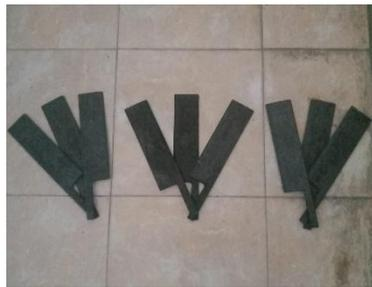
Gambar 4.1 Spesimen Hasil Perlakuan Panas
