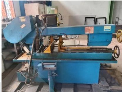
Gambar 3.8 Mesin Gergaji Potong DOALL Model C-916
