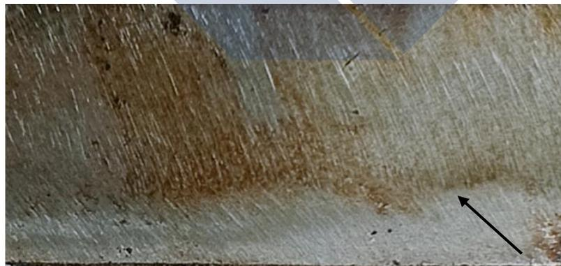
Gambar 4.29 Sampel yang Mengalami Perlakuan Panas Selama 3 Jam
