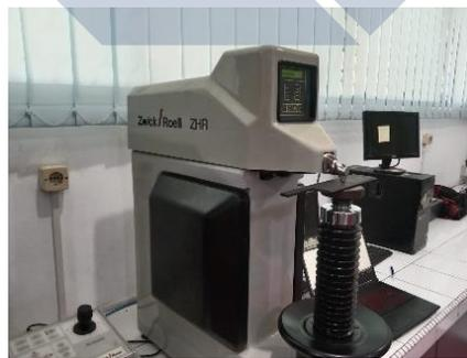
Gambar 3.9 Mesin Uji Kekerasan Zwick-Roell ZHR
