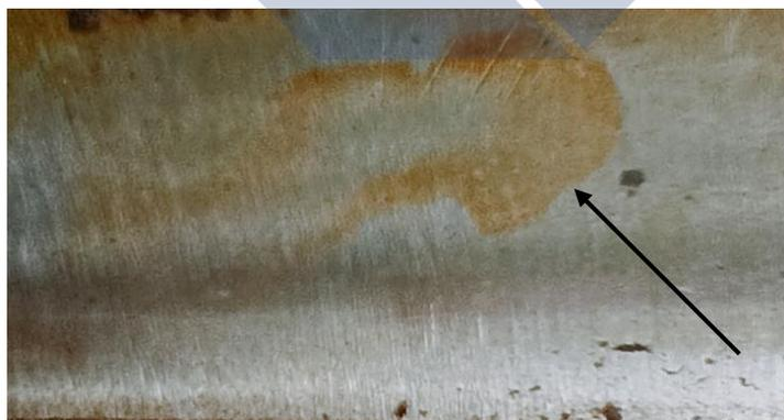
Gambar 4.27 Sampel yang Mengalami Perlakuan Panas Selama 5 Jam
