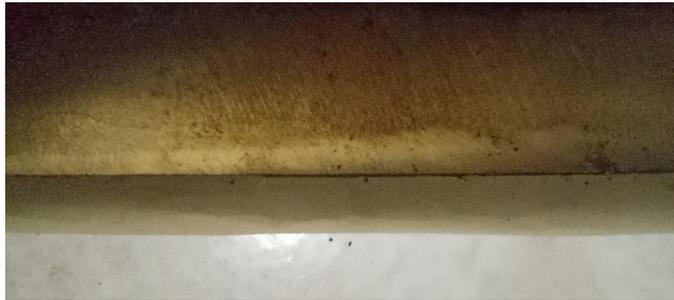
Gambar 4.23 Mata Potong Sampel yang Mengalami Perlakuan Panas Selama 3 Jam
