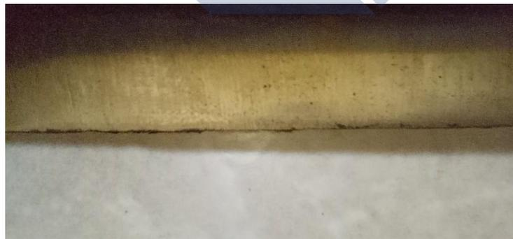
Gambar 4.24 Mata Potong Sampel yang Mengalami Perlakuan Panas Selama 4 Jam
