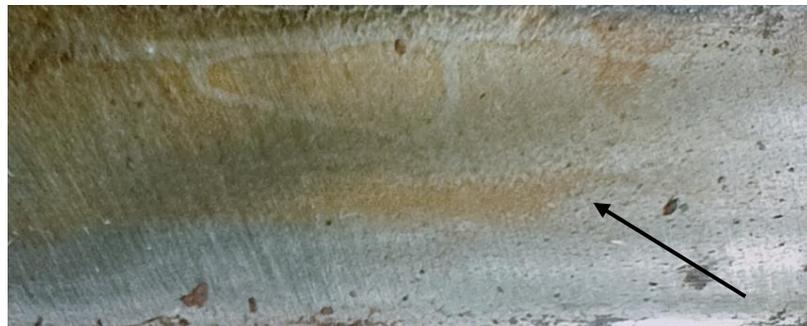
Gambar 4.28 Sampel yang Mengalami Perlakuan Panas Selama 4 Jam
