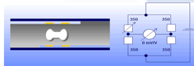
Gambar 2. 7 Loadcell Ketika Tidak ada Beban [19]
