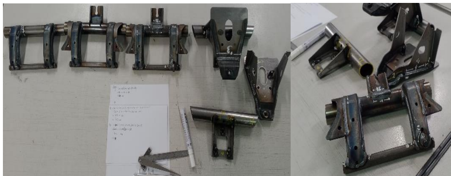
Gambar 2. 20 Pengukuran panjang welding
