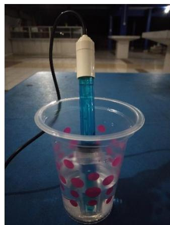
Gambar 4.5 Pengujian pH Air Menggunakan Alat Ukur pH Meter
