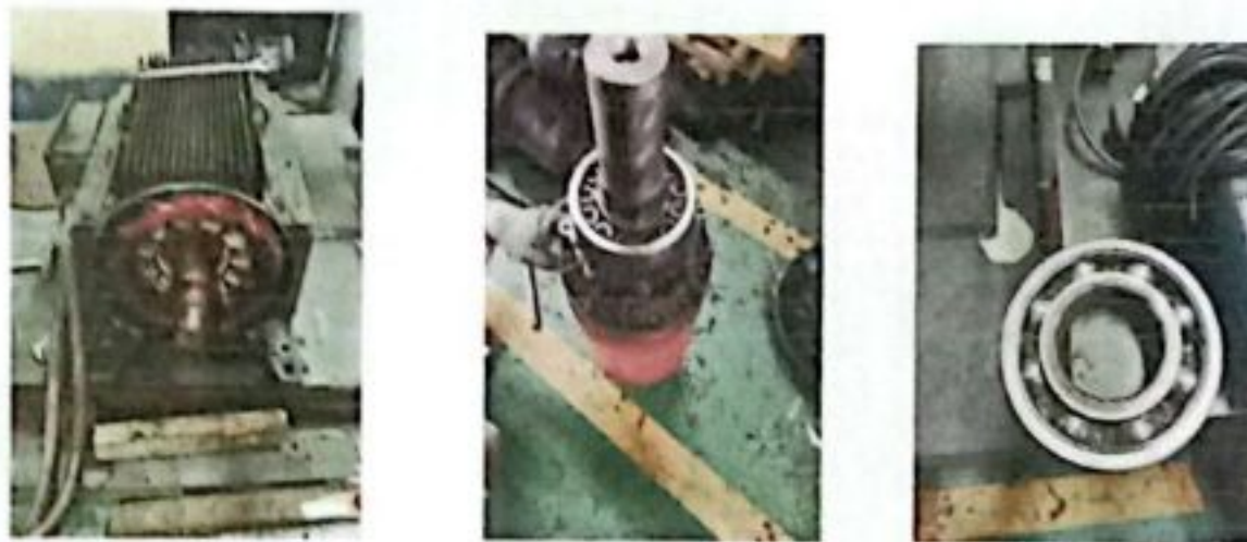
Gambar 2. 4 proses penggantian dinamo mesin press
