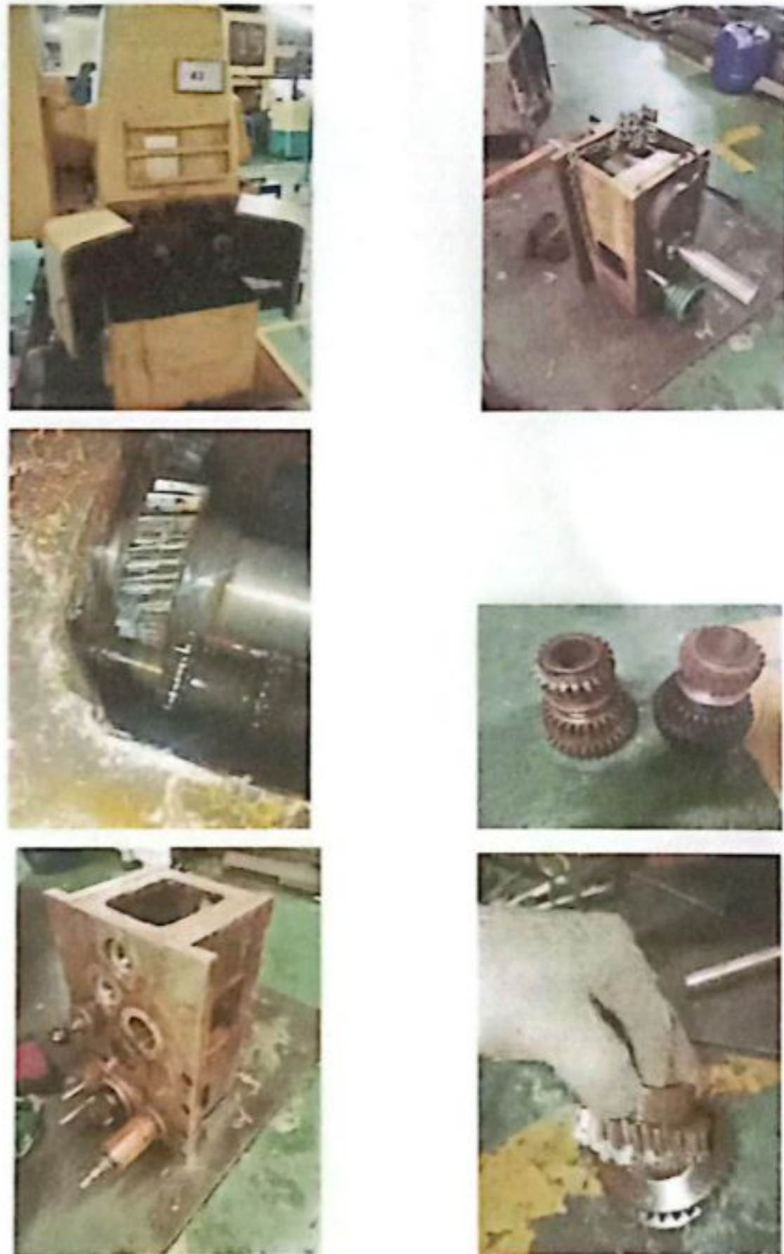
Gambar 2. 11 dokumentasi proses overhoul gearbox transmisi.
