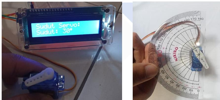
Gambar 4.4 Hasil Data Pengujian Motor Servo
