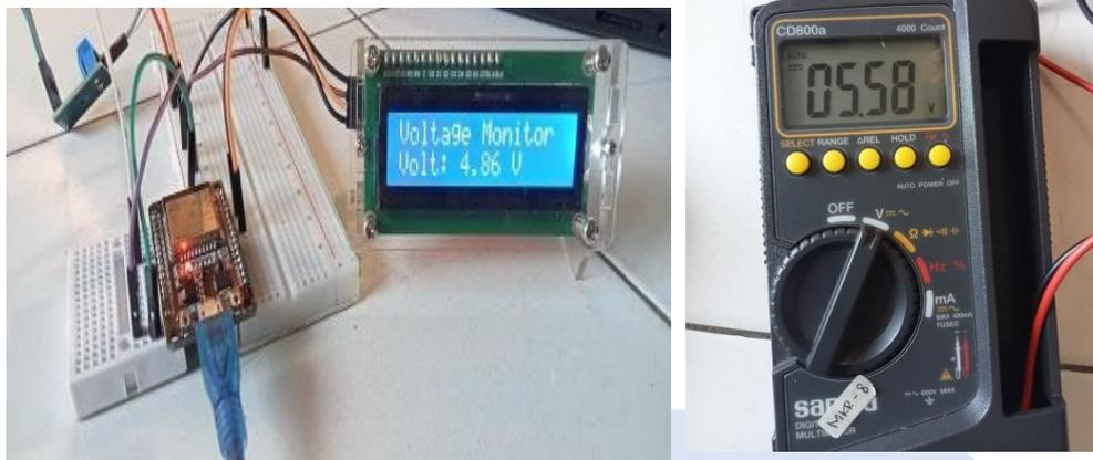
Gambar 4.2 Pengujian Sensor Tegangan
