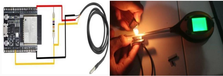
Gambar 4.5 Rangkaian Pengujian Sensor DS18B20
