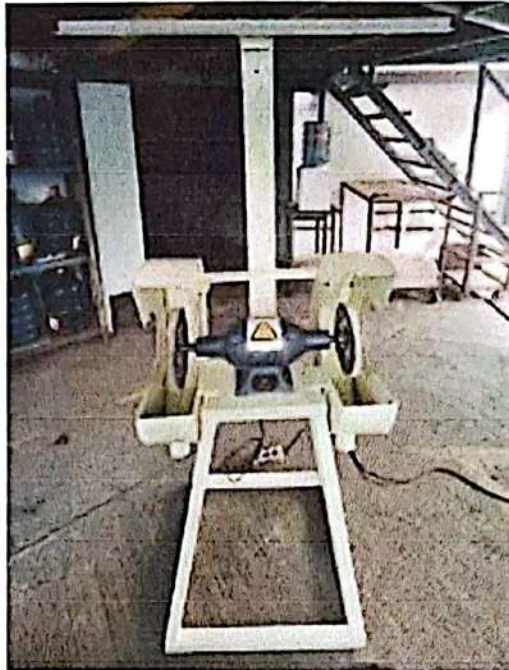
Gambar 2.2 Gambar meja unntuk proses buffing yang lebih safety
