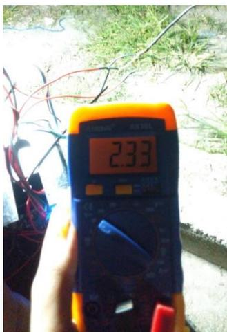
*Gambar 4. 5 Pengujian Generator tanpa menggunakan Beban*
