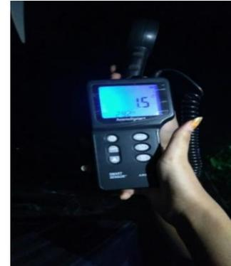
Gambar 4. 9 Pengukuran Rpm alat menggunakan Tachometer
