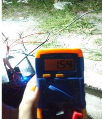
Gambar 4. 8 Pengukuran Rpm manual Menggunakan Voltmeter
