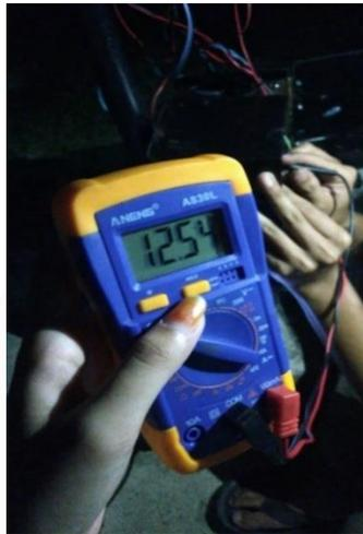
*Gambar 4. 6 Pengujian Baterai tanpa beban lampu*
