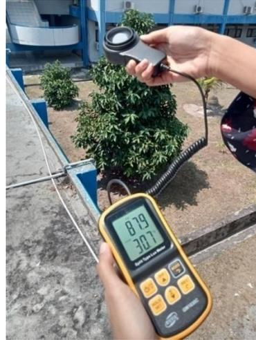
Gambar 4.21 Pengukuran Intensitas Matahari Menggunakan Lux Meter
