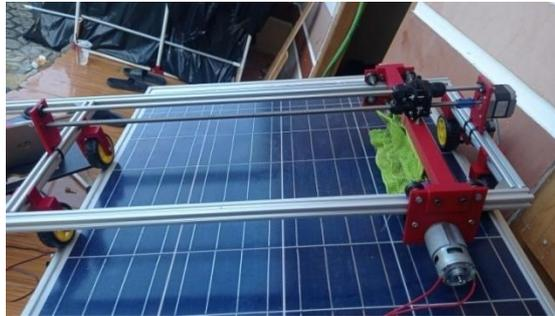
Gambar 4.6 Tampak Depan Kontruksi Robot Pembersih
