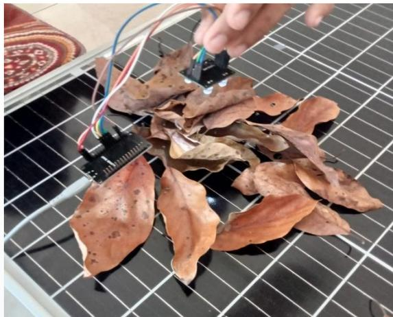
Gambar 4.15 Pengujian Sensor Warna pada objek daun kering
