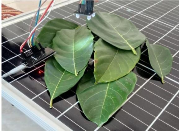
Gambar 4.14 Pengujian Sensor Warna TCS3200 pada objek daun hijau
