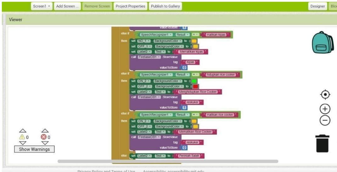
**Gambar 4. 5Program Pengujian Alat dengan perintah Suara**
