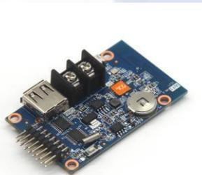
**Gambar 2. 4 Mikrokontroler Huidu WF1**
