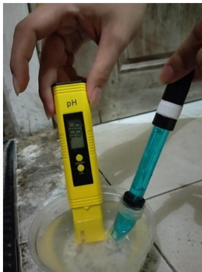
Gambar 4.9 Pengujian Sensor pH dan pH meter
