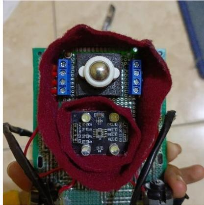
Gambar 4. 2 Pemasangan Sensor Warna TCS3200
