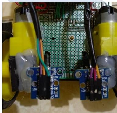
Gambar 4. 3 Pemasangan Sensor HC 020K
