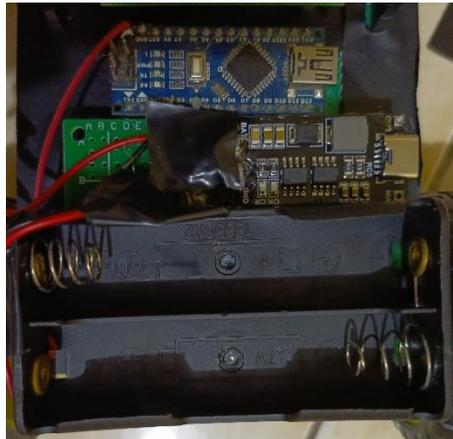
Gambar 4. 4 Pemasangan Modul BMS 2S
