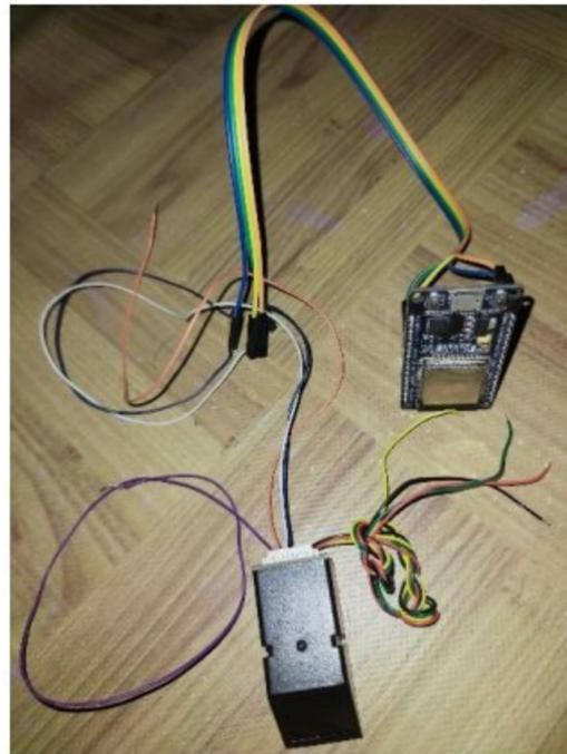
Gambar 4. 12 *Wiring* atau Rangkaian Sensor *Fingerprint* dengan ESP32
