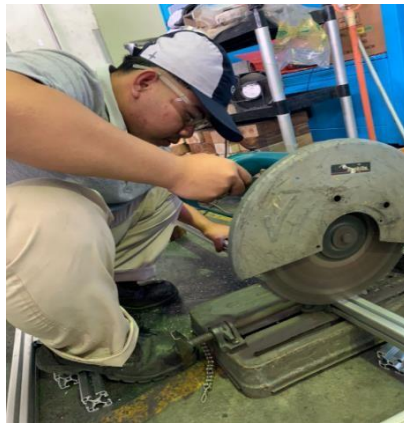
Gambar 2. 6 Pemotongan Alumunium Profile V 4x4
