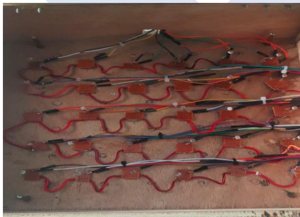
Gambar 3. 10 Perakitan sensor LDR
